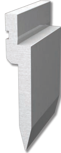
US 137/26° R0,8 altezza-height 117,00 mm angolo-degree 26° raggio-radius 0,8 mm 42CrMo4 rettificato-grinding temprato ind.-induction hardened HRC 52/58 lunghezze-lengths 835 mm - 415 mm - fraz
