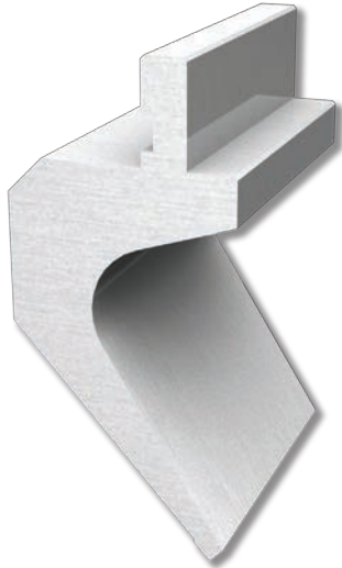
US 145/85° R2,0 altezza-height 145,00 mm angolo-degree 85° raggio-radius 2,0 mm 42CrMo4 rettificato-grinding temprato ind.-induction hardened HRC 52/58 lunghezze-lengths 835 mm - 415 mm - fraz
